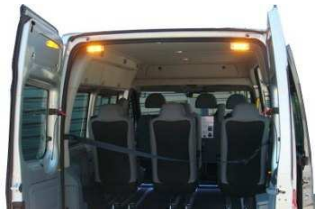
Rappel de feux de détresse
