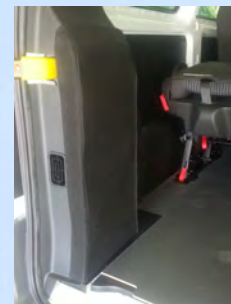
Modification de la clim AV/AR pour 4 fauteuils roulants (L2).
